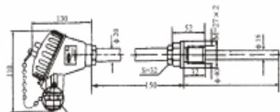
无固定装置 固定卡套螺纹
